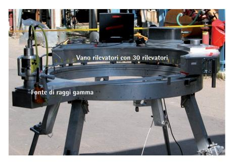
Tomografia computerizzata su una tubazione di ingresso da 10" di un idrogenatore idrocarburi a flusso ascendente
