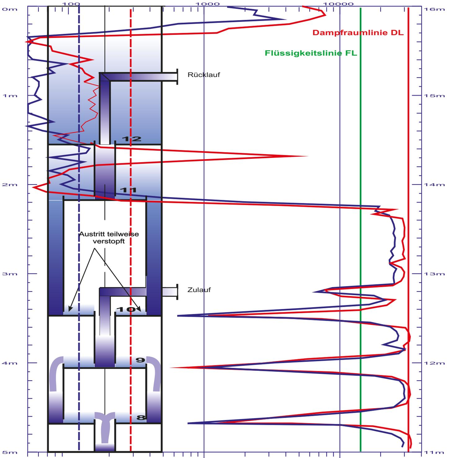
Schachtfluten ist eine Funktion von Druckverlust über die aktive Bodenfläche, Schachtgeometrie, Flüssigkeitsmenge, Viskosität, Oberflächenspannung, Verweilzeit, Entgasungsgrad abhängig von der Dichtedifferenz von Flüssigkeit / Dampf
