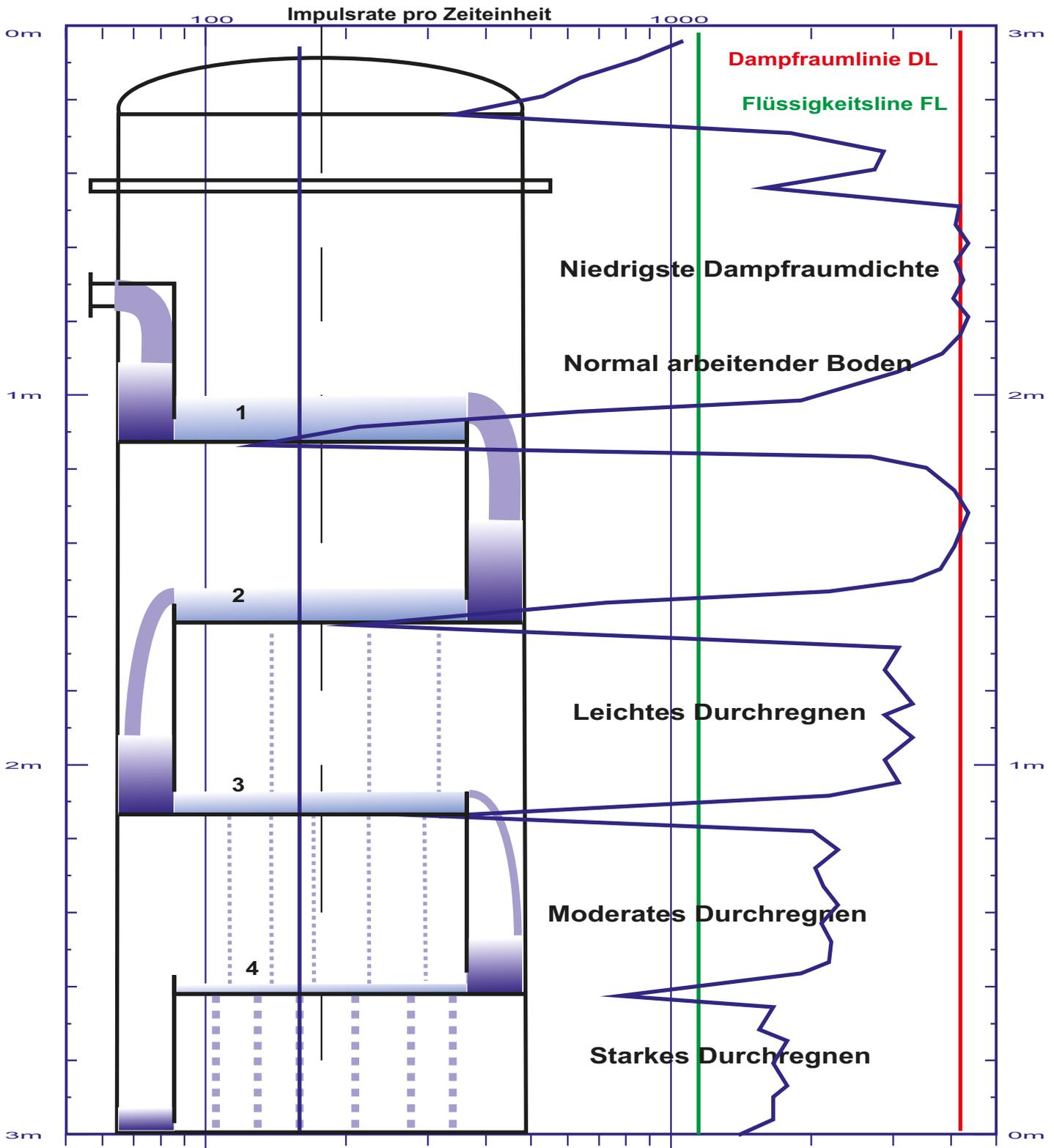
Der Grad des Durchregnens hängt ab von Dampfgeschwindigkeit, Dampfdurchtrittsfläche, Flüssigkeitsmenge / Wehrhöhe, Bodentyp
